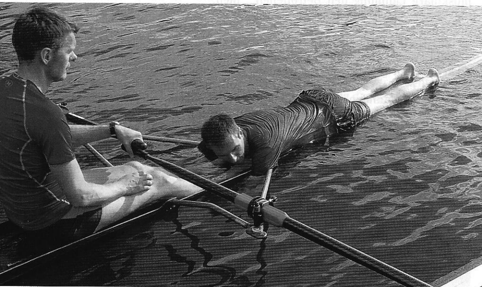
Rettung eines Gekenterten: Der Ruderer legt sich mit dem Oberkörper über das Boot. Selbst ein Renneiner trägt dank des hinteren Luftkastens die Last.
